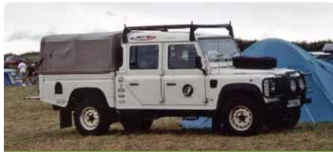
NADWOZIE PIKAP NA NAJDŁUŻSZEJ WERSJI PODWOZIA
